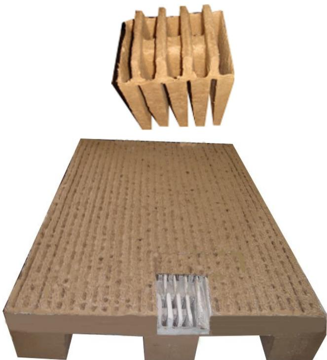
Грузовой поддон из формованной макулатуры отличаются от аналогов тем, что ребра жесткости в виде двойной гофроплиты, а также стенки ребристых вкладышей стоек могут быть **толщиной до 10 мм**. При этом, технологическая подпрессовка и сушка деталей поддона при температуре до 250 град.С, позволяет получить плотность ребер жесткости до 0.5 кг/см кв., что сопоставимо с плотностью древесины хвойных пород.
