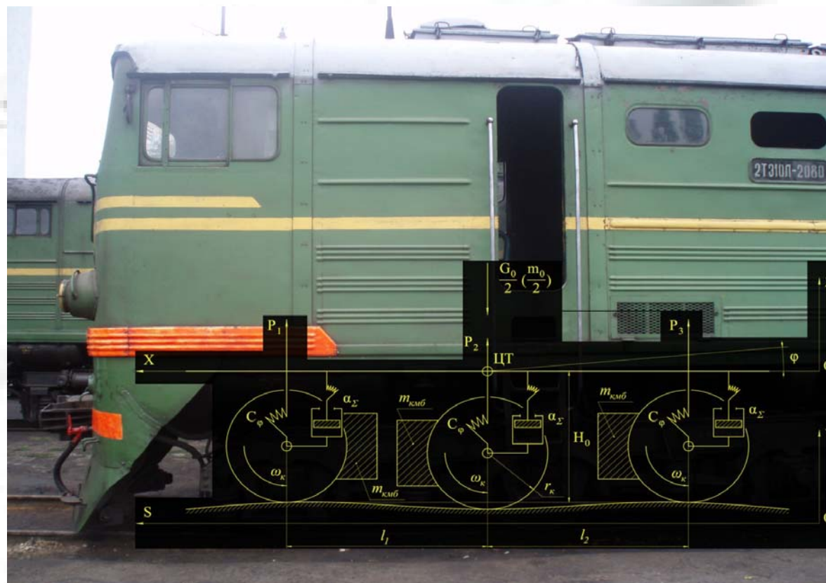
Рис. 21. Перспективное торсионное подвешивание тепловоза 2ТЭ10Л
