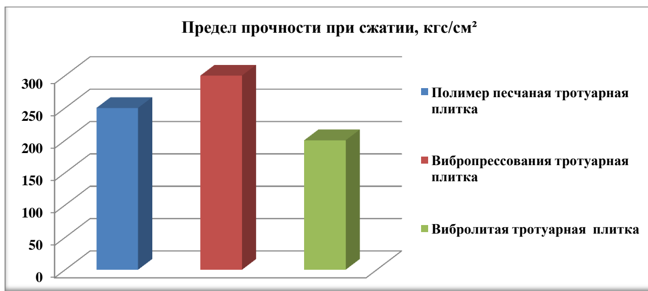
Диаграмма № 3. Сравнительные показатели предела прочности при сжатии разных тротуарных плиток.
