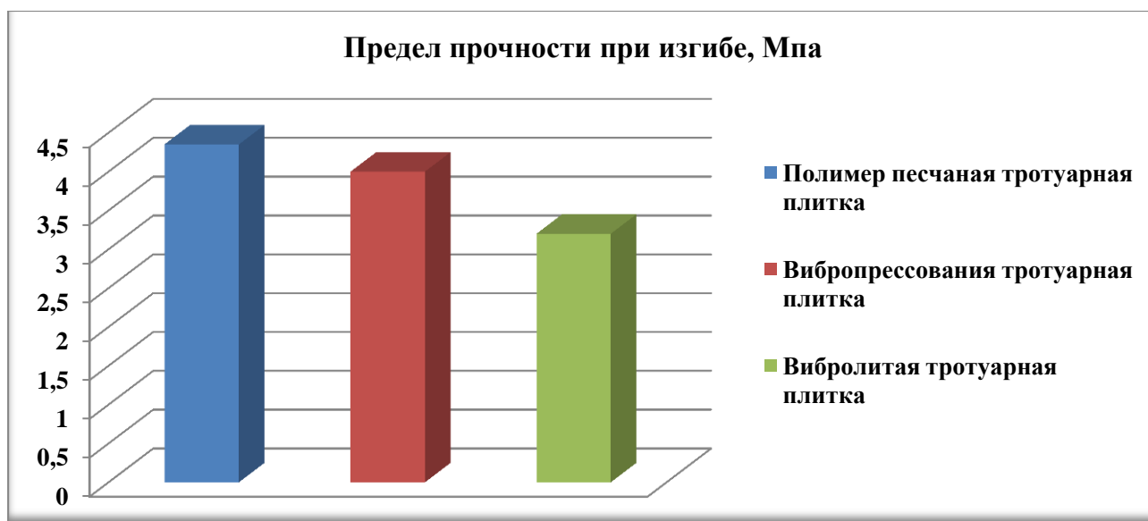
Диаграмма № 4. Сравнительные показатели предела прочности при изгибе разных тротуарных плиток.
