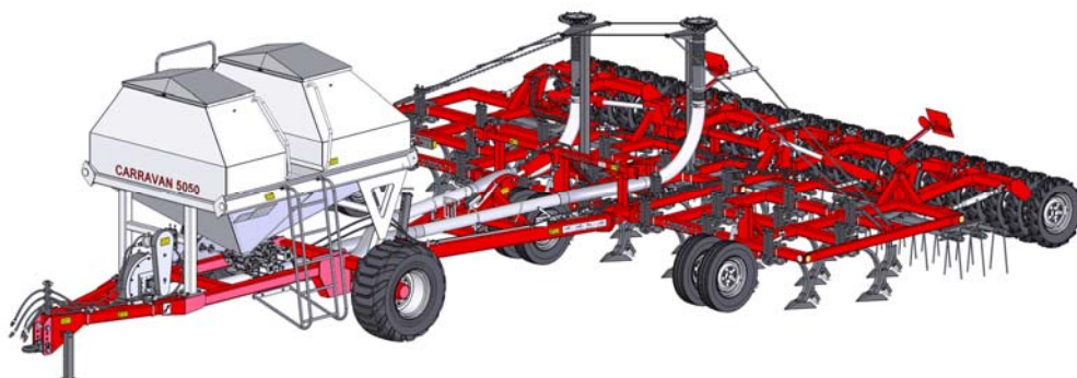
Рис.1 Посевной комплекс COMMON 7,2-F (семяпроводы условно не показаны)
